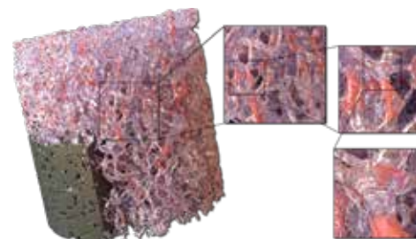
Echantillon de grès sableux et son réseau de pores en transparence (zones d'accélération en rouge). Calcul du champ de vitesse à haute résolution, ici 1024^3 (tiré de [4]).
