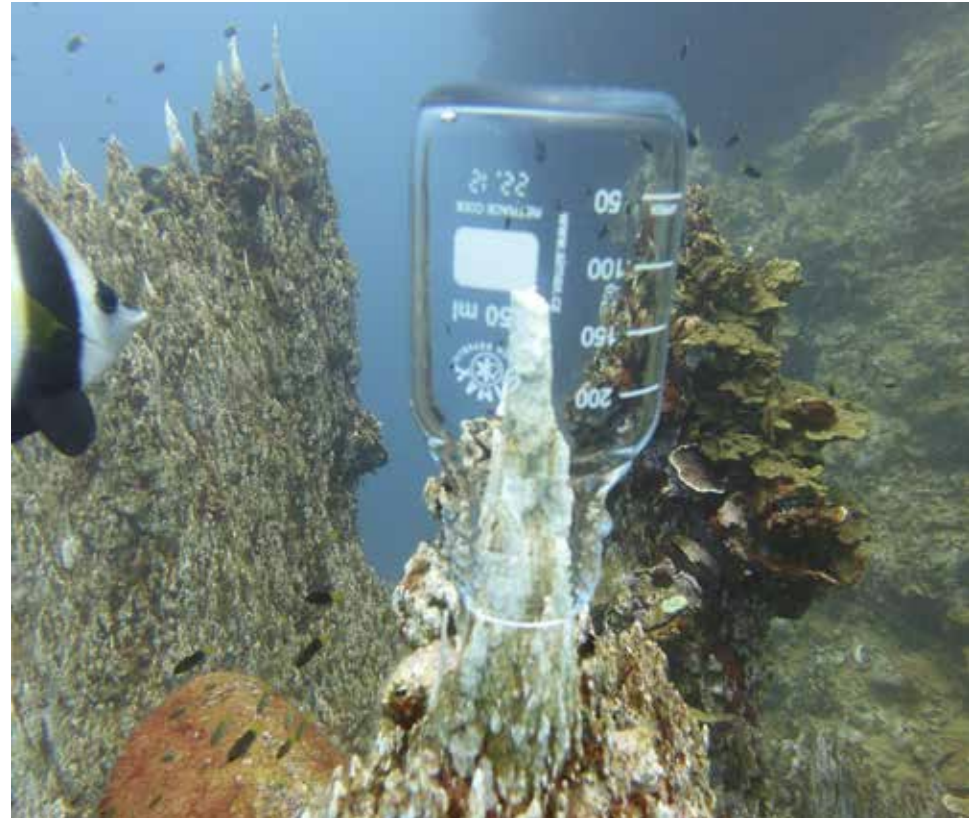
Dispositif pour prélever les fluides hydrothermaux (fluides gazeux) au site de l'Aiguille (17 m de profondeur), Baie de Prony, Nouvelle Calédonie
