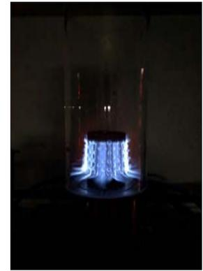
*Exemple de flamme stabilisée sur un brûleur de chaudière domestique.*
